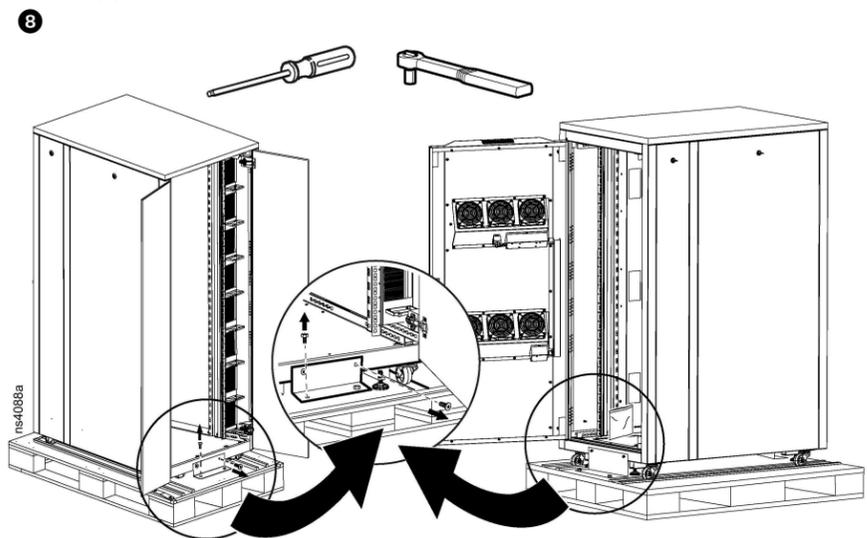
9. Retirez le boulon de fixation du support de rampe (A) fixé à la palette. Retirez le boulon de fixation du deuxième support de rampe (B) qui est installé sur la rampe. Des boulons de rampe supplémentaires sont fournis sur la palette et la rampe.
