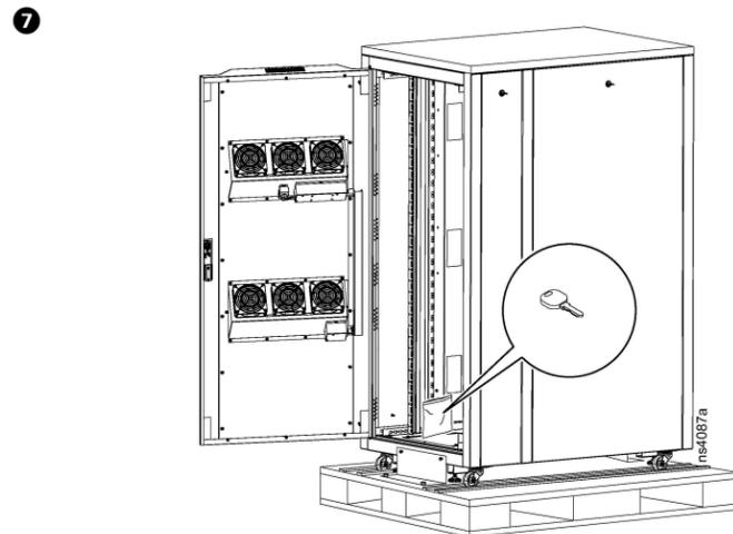
8. Déverrouillez et ouvrez les portes avant. Retirez les deux (2) vis Torx T-30 qui fixent chaque support (avant et arrière) au armoire. Utilisez une douille de 13 mm pour retirer les deux (2) boulons de 10 x 20 qui fixent chaque support à la palette.
