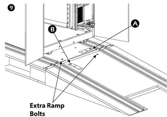
10. Fermez les portes. Fixez la rampe à la palette à l'aide des supports et des boulons fournis.
