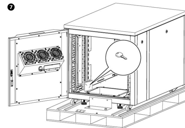
8. Déverrouillez et ouvrez les portes avant. Retirez les deux (2) vis Torx T-30 qui fixent chaque support au armoire. Utilisez une douille de 13 mm (non fournie) pour retirer les deux (2) boulons de 10 x 20 qui fixent chaque support (avant et arrière) à la palette.
