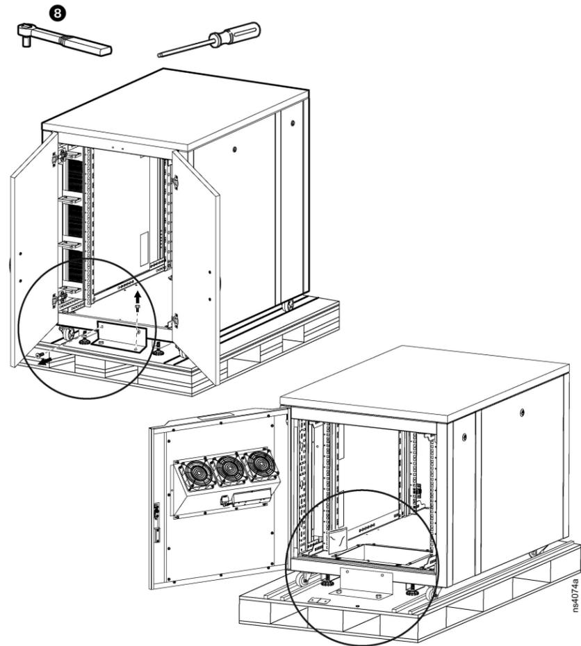
9. Retirez le boulon de fixation du support de rampe (A) fixé à la palette. Retirez le boulon de fixation du deuxième support de rampe (B) qui est installé sur la rampe. Des boulons de rampe supplémentaires sont fournis sur la palette et la rampe.
