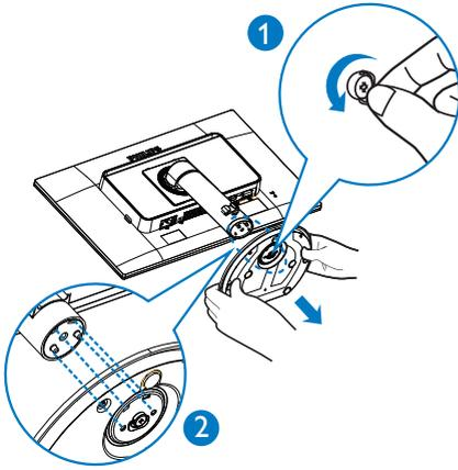
3. Entfernen Sie die Schrauben von der Gelenkabdeckung.
