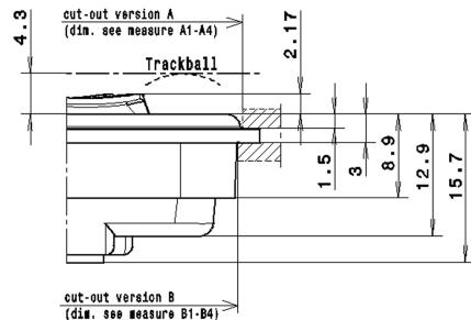
Alle Maße in Millimetern / All measurements in millimeters / Toutes cotes en millimètres /
