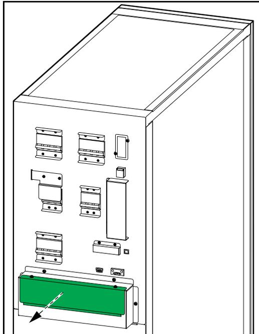
3. Pour les ASI configurées avec double réseaux d'alimentation, retirez les trois supports d'alimentation secteur simple.
