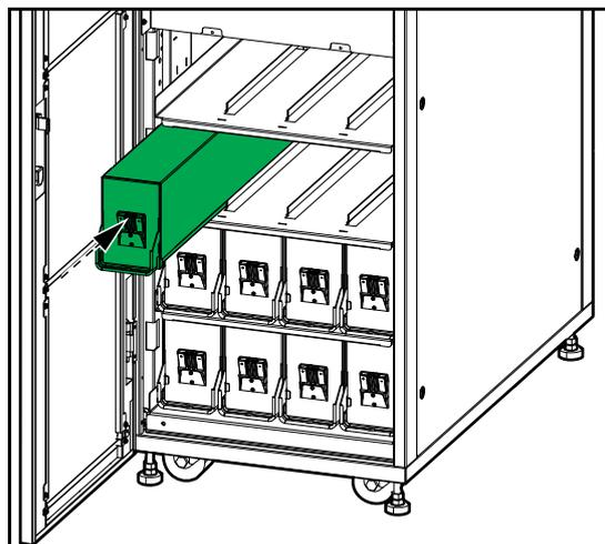
3. Abaissez la poignée de chaque module de batterie et fixez-la avec la vis fournie à l'avant du module de batterie.
