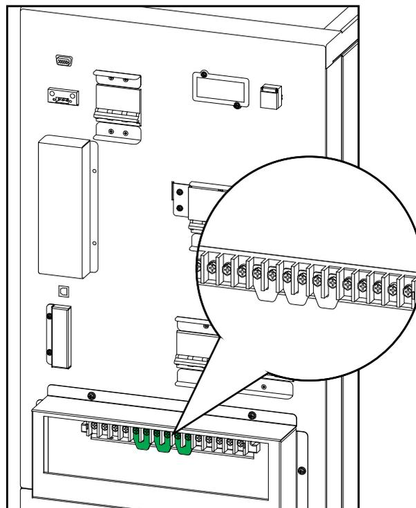
4. Acheminez les câbles d'alimentation via la partie inférieure du boîtier de câblage.
