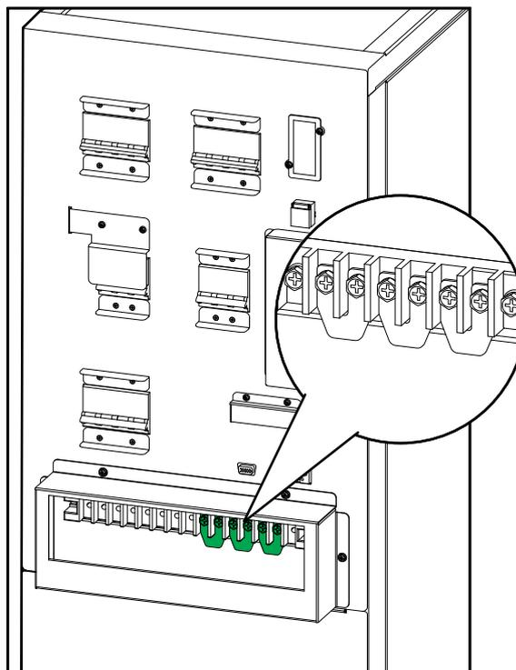
4. Acheminez les câbles d'alimentation via la partie inférieure du boîtier de câblage.
