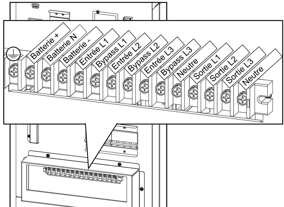
6. Raccordez les câbles d'entrée, de sortie et de bypass (le cas échéant).
