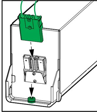
4. Retirez les gaines thermo-rétractables des bornes d'alimentation et branchez ces dernières aux batteries.
