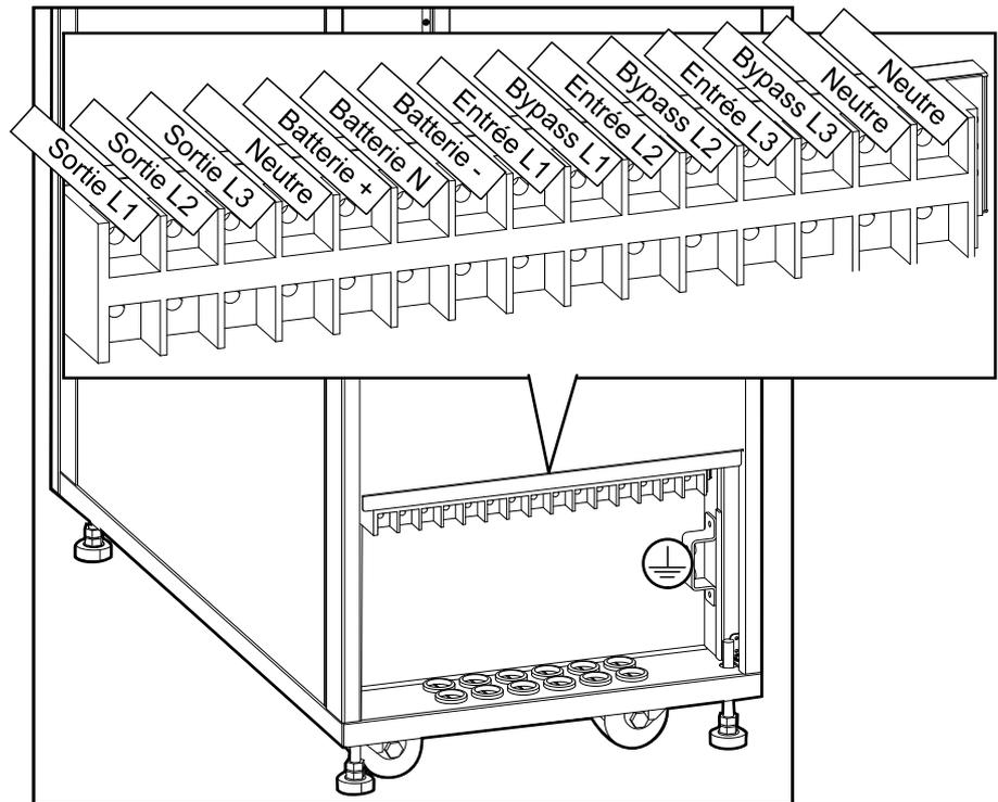
6. Raccordez les câbles d'entrée, de sortie et de bypass (le cas échéant).
