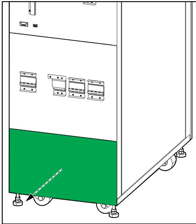
3. Pour les ASI configurées avec double réseaux d'alimentation, retirez les trois supports d'alimentation secteur simple.
