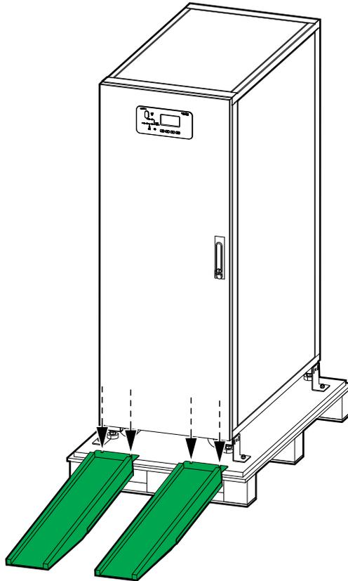
4. Desserrez les vis et retirez les supports d'expédition. Mettez ces derniers au rebut.
