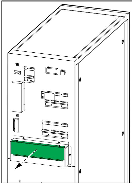
3. Pour les ASI configurées avec double réseaux d'alimentation, retirez les trois supports d'alimentation secteur simple.
