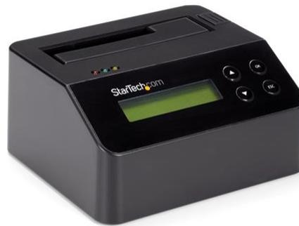
Cet effaceur de disques durs vous permet d'effacer un disque dur ou SSD SATA sans nécessitant une connexion à un ordinateur hôte. Il est compatible avec les disques 2,5" et 3,5" SATA I, II et III, et de grande capacité, y compris les disques 4Kn.
