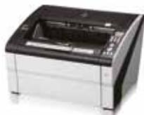
Les impressionnantes vitesses de numérisation font du fi-6800 un appareil à part. A une résolution de 300 dpi en mode paysage A4, il peut numériser 130 pages par minute, en mono ou en couleur. Il double sa production à 260 images par minute en duplex. Le chargeur automatique accepte un maximum de 500 pages.
