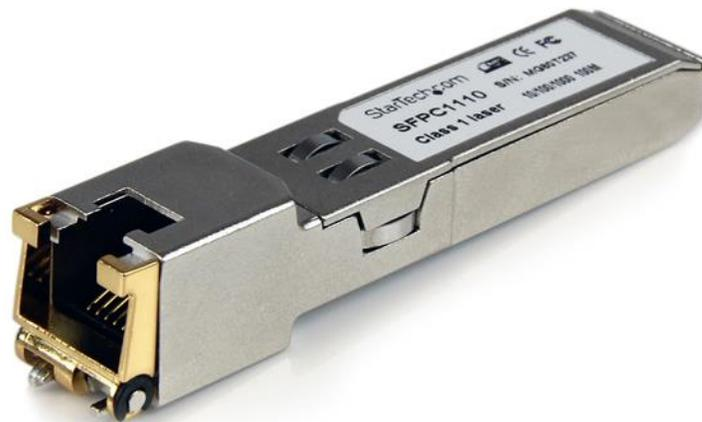
Le modèle SFPC1110 est un module de transceiver en cuivre compatible avec Cisco SFP-GE-T, qui a été conçu, programmé et testé pour fonctionner avec les commutateurs et routeurs de la marque Cisco®. Il fournit une connectivité 1 GbE (1 000 Mbit/s) fiable sur câble en cuivre pour les réseaux conformes aux spécifications 1000BASE-T, avec une distance maximale de 100 m.
