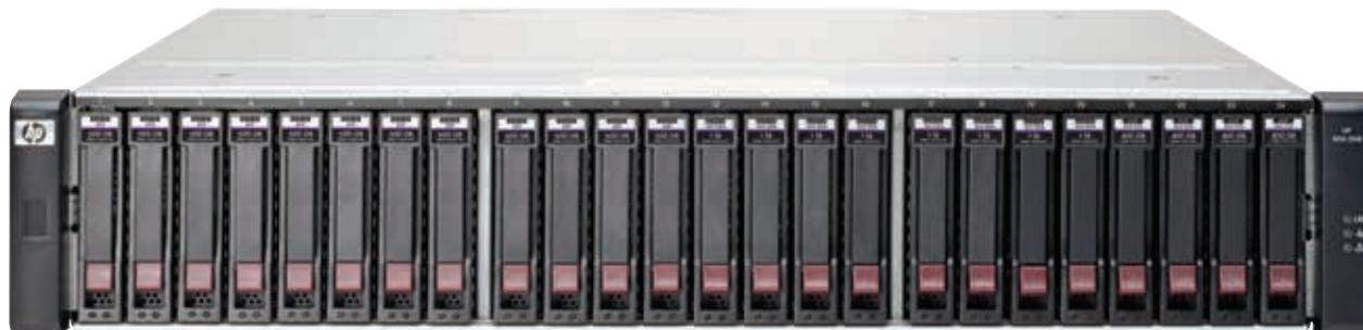
La nouvelle baie MSA est équipée de deux contrôleurs hautes performances prenant en charge les dernières interfaces hôtes Fibre Channel, iSCSI et SAS du secteur. Le modèle MSA 2040 propose des fonctionnalités pour les entreprises de taille moyenne aux clients SAN d'entrée de gamme qui souhaitent utiliser les dernières technologies SDD et de disques durs. Ce modèle est facile à déployer et simple à gérer.
