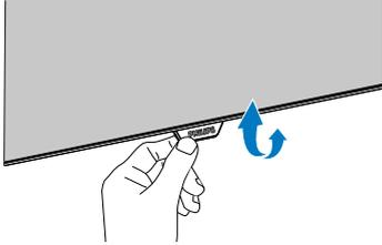
Si la structure PowerSensor dans votre moniteur est de type pliable, veuillez vous assurer qu'il est déplié afin qu'il fonctionne correctement. Vous pouvez activer ou désactiver PowerSensor via la commande OSD. Veuillez noter que dans la position pliée, PowerSensor ne s'activera pas même si l'OSD est réglé en mode "Activé".
