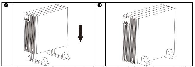
**REMARQUE**: Maintenez une distance d'environ 70 mm du bord de l'unité lors de l'installation des supports de stabilisation sur un onduleur Easy UPS.
