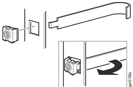
Insérez l'écrou à cage dans le trou carré par l'intérieur de l'armoire.
