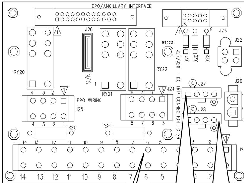
**Câblage d'entrée/de sortie de l'équipement auxiliaire**
