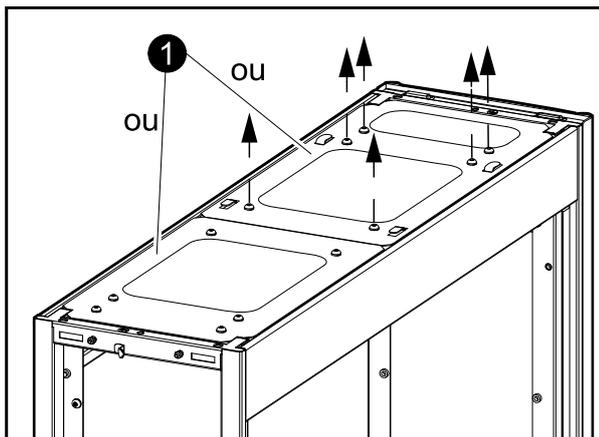
2. Percez des trous dans le panneau supérieur en vue d'y insérer les conduits et remontez le panneau supérieur avec les conduits installés.
