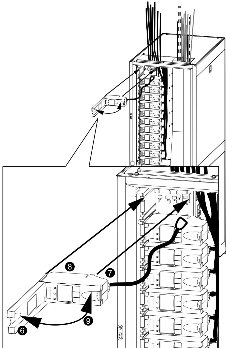
10. Basculez en position ON (fermés) les disjoncteurs nécessaires du module de distribution électrique installé.
