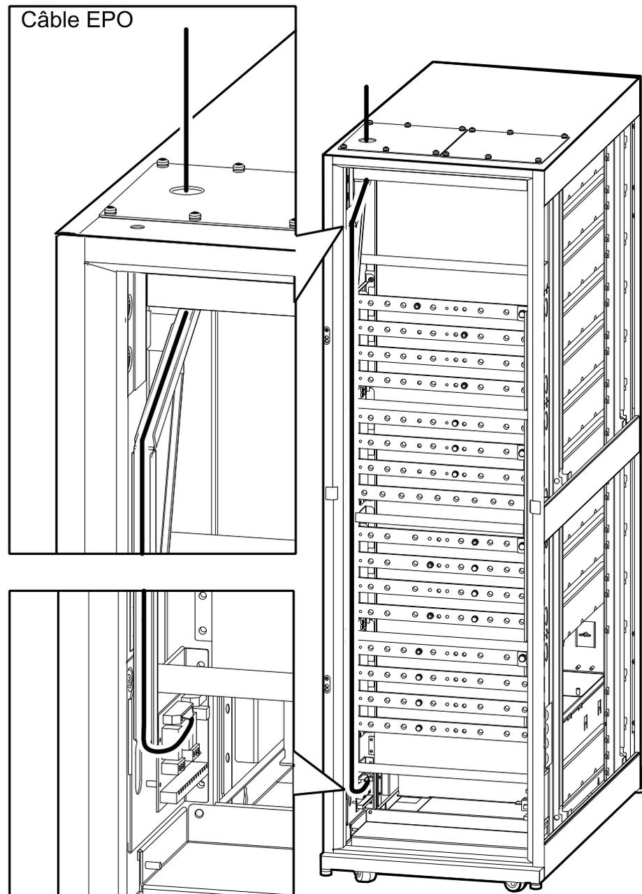
L'ASI doit être connectée soit à un contact sec, soit à une source d'alimentation 24 V CC externe.
