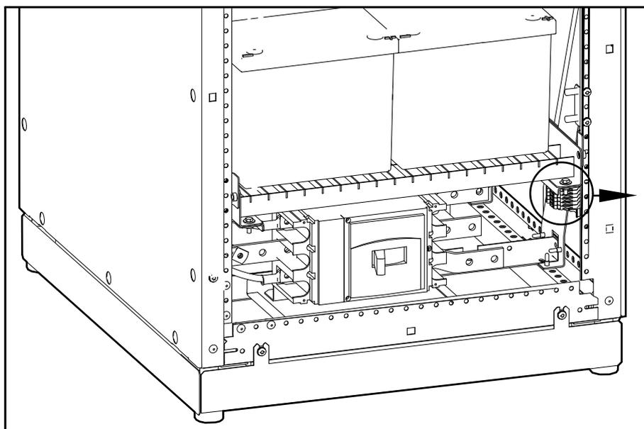
**REMARQUE:** Retirer la plaque métallique et le bornier de l'armoire lors de l'installation des câbles n'est pas obligatoire mais facilite l'installation des câbles en raison de l'espace limité à l'intérieur de l'armoire.
