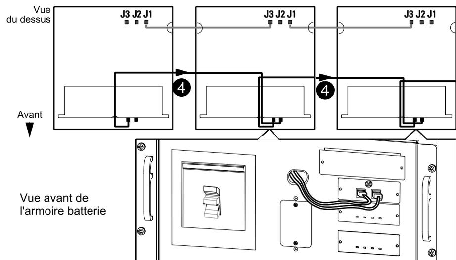
5. Acheminez le câble de communication du port de communication XR 1 de la dernière armoire batterie modulaire de la rangée au port de communication XR 2 de l'ASI.
