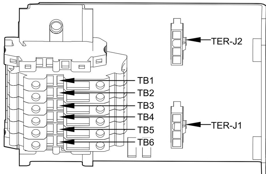
3. Acheminez le câble de signal du bornier de l'armoire batterie classique (TB1, TB2, TB3, TB4) jusqu'aux bornes de terminal du circuit imprimé (J21/7, J21/8, J21/3, J21/6) de l'ASI. Le couple de serrage du bornier est de 0,6 Nm.
