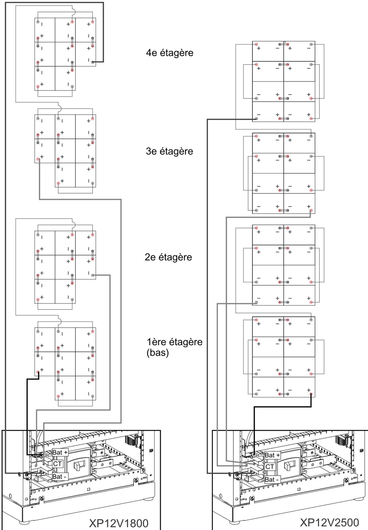
6. **Si vous installez plusieurs armoires batterie classique :** Raccordez les câbles BAT+, BAT- et CT (centre) en connexion parallèle entre les armoires batterie classique (sortie à sortie) par groupes de deux ou trois. Vous pouvez relier jusqu'à quatre armoires batterie classique à l'ASI.
