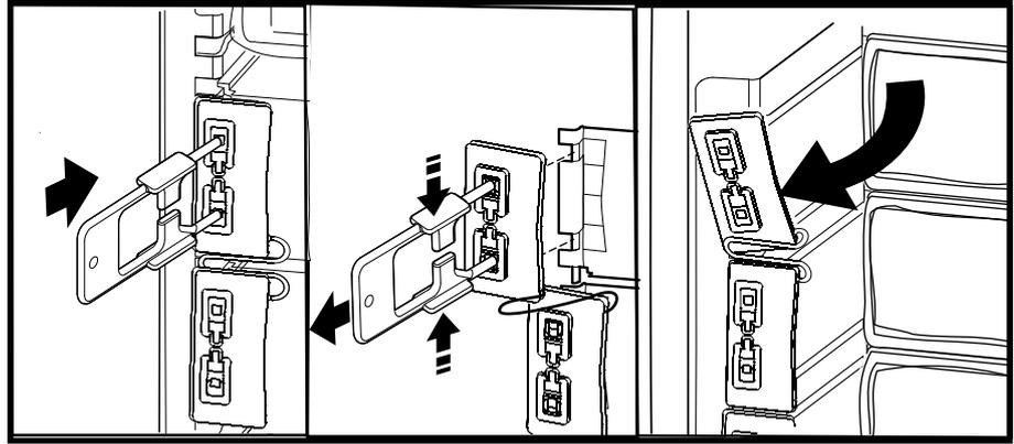
5. Pour retirer un obturateur : appuyez sur la fixation de l'obturateur pour déverrouiller le mécanisme de verrouillage, et tirez horizontalement sur l'obturateur.
