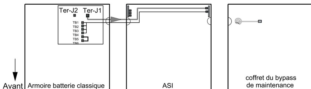
5. Attachez les câbles de signal à la plaque métallique inférieure de l'armoire batterie classique et au séparateur de câbles de la plaque de l'ASI à l'aide de frettes.
