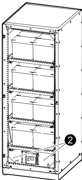
3. Enlevez les vis fixant la plaque métallique et le bornier au côté droit des armoires batterie et enlevez ces derniers.
