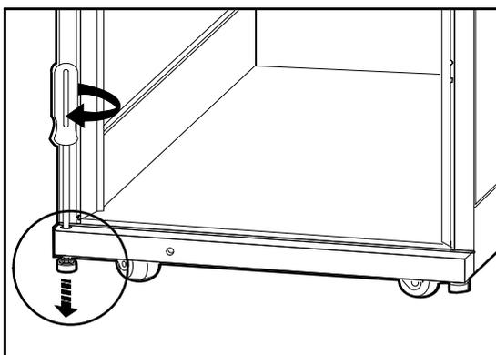
2. Réglez les quatre pieds à l'aide d'une clé et vérifiez que l'armoire est à niveau.
