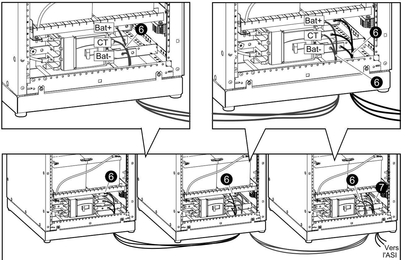
**Installation avec deux ou quatre armoires batterie classique**
