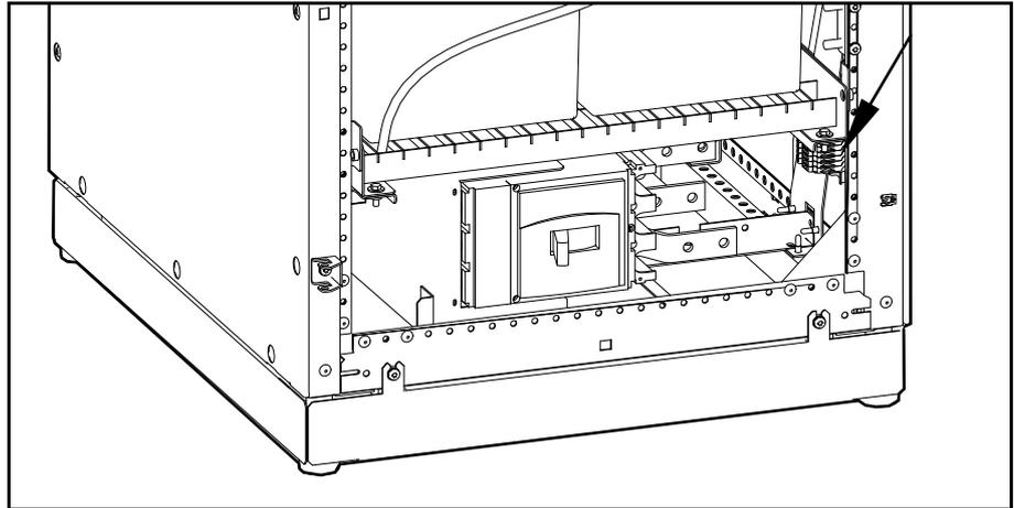
2. Acheminez le câble de signal du bornier de l'armoire batterie classique (Ter J1) jusqu'au circuit imprimé (OP4123 J27) de l'ASI.
