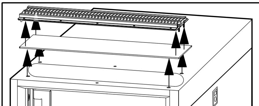
2. Percez autant de trous que nécessaire dans le panneau plein et insérez-y les conduits. Remontez le panneau plein.
