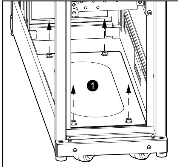
2. Percez des trous dans le panneau inférieur en vue d'y insérer les conduits, et remontez le panneau inférieur avec les conduits installés.
