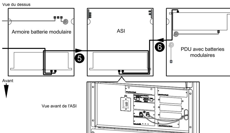
7. Acheminez les trois câbles de communication de la PDU avec batteries modulaires aux ports J7, J8 et J1 de la carte d'interface de bypass de maintenance (0P3199) de l'ASI.
