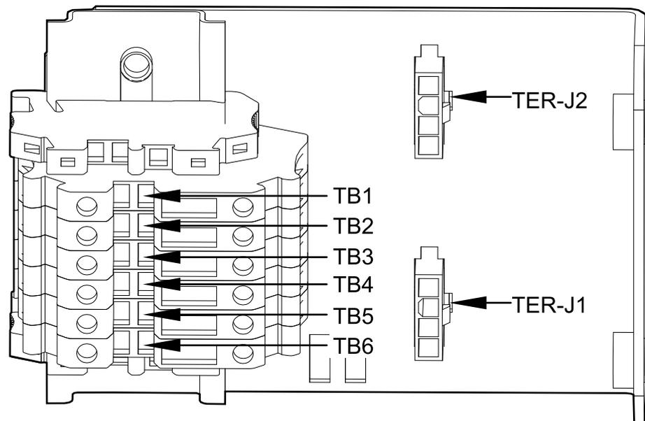
3. Acheminez le câble de signal du bornier (TB6,TB5) dans l'armoire batterie classique 1 jusqu'au bornier (TB3,TB4) de l'armoire batterie classique 2.
