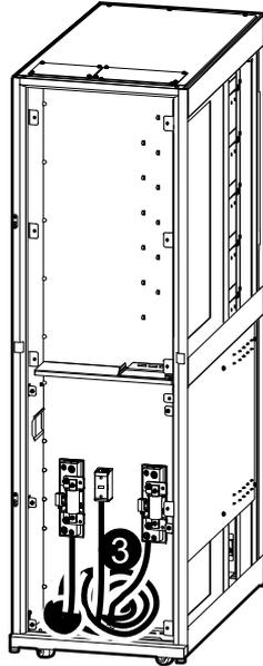
4. Raccordez d'abord le câble de mise à la terre, puis les câbles BAT+, BAT- et CT (centre) entre les armoires batterie modulaire. Jusqu'à trois armoires batterie modulaire peuvent être reliées en cascade.
