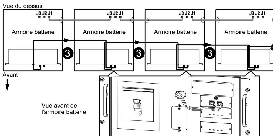
4. Acheminez le câble de communication du port de communication XR 1 de la dernière armoire batterie modulaire au port de communication XR 2 de l'ASI.
