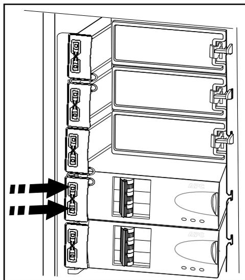
13. Raccordez le câble du module de distribution électrique à l'équipement approprié.
