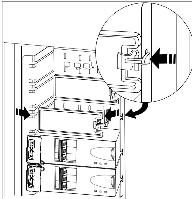
6. Appuyez sur le bouton rouge pour ouvrir le loquet à l'avant du module de distribution électrique.
