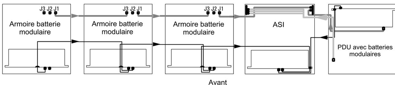
1. Acheminez le câble de disjoncteur de batterie du port J1, dans la première armoire batterie modulaire, au port J3, dans l'armoire batterie modulaire adjacente. Répétez la procédure pour toutes les armoires batterie modulaire.
