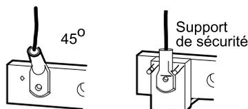
Schneider Electric recommande l'utilisation d'une cosse de câble 45°. Si vous utilisez des cosses de câble droites, posez un support de sécurité entre chaque jeu de barres et cosse de câble pour les séparer de manière sécurisée. Les supports sont fournis avec l'ASI.
