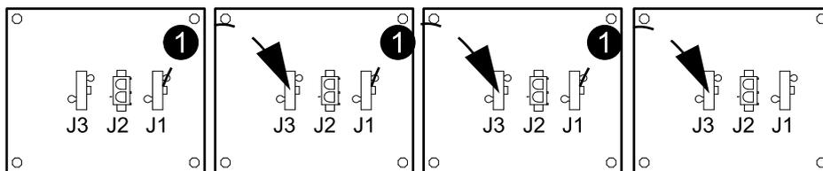
2. Acheminez le câble de disjoncteur de batterie de J1, dans la dernière armoire batterie modulaire, à J27, sur la carte d'interface/de mise hors tension d'urgence (OP4123) de l'ASI.
