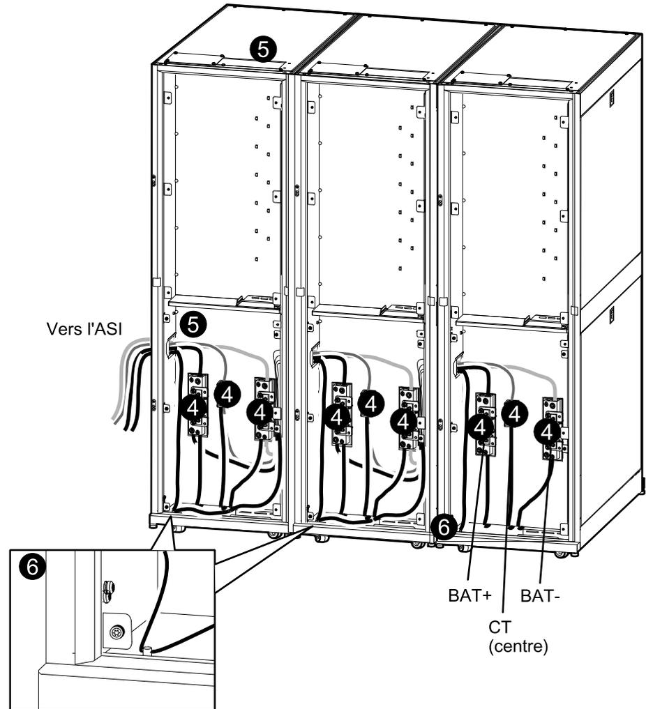
6. Raccordez le câble de mise à la terre de l'équipement à l'armoire batterie modulaire la plus éloignée de l'ASI. Acheminez-le jusqu'à l'ASI par le côté, le haut ou le bas de l'armoire batterie modulaire, en le faisant passer par chaque armoire batterie modulaire.
