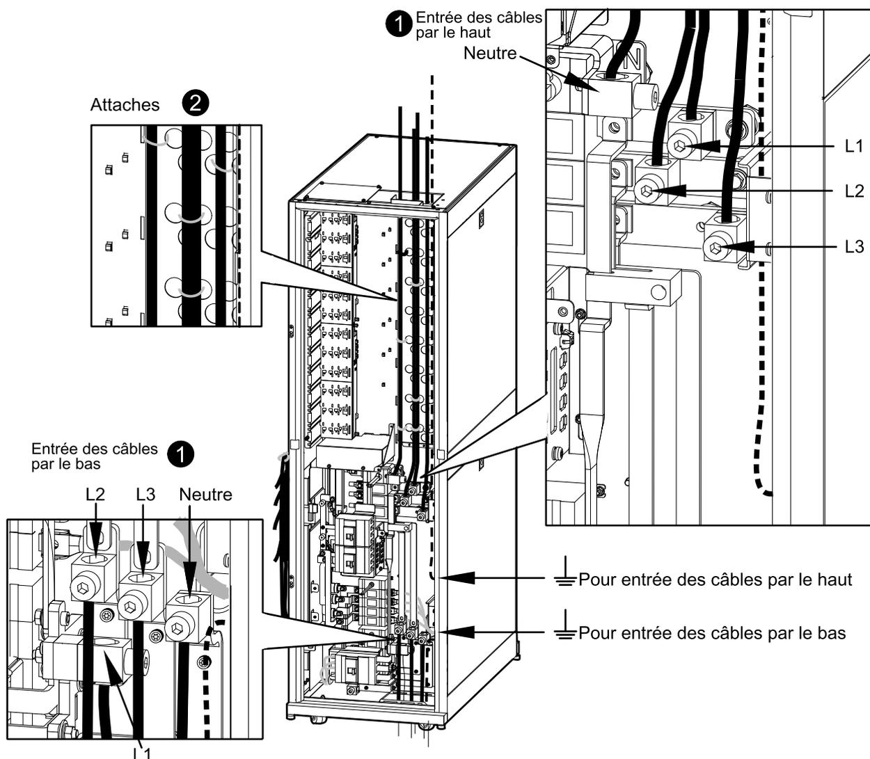
**REMARQUE:** Acheminez les câbles d'entrée en serrant sur la droite pour garder de la place pour les câbles du module de distribution électrique qui seront raccordés plus tard.
