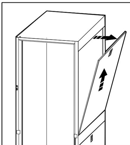
3. Pour poser les panneaux latéraux, placez la base du panneau à l'oblique et poussez le panneau vers l'intérieur. Verrouillez les panneaux latéraux à l'aide de la clé.
