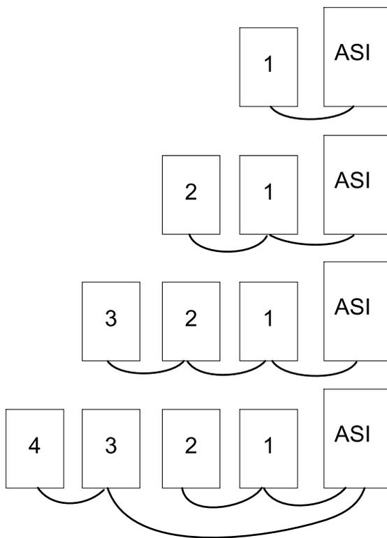
**REMARQUE:** Pour les installations avec quatre armoires batterie, deux ensembles de câbles de batterie seront utilisés (un pour chaque groupe d'armoires batterie classique) pour la connexion à l'ASI.
