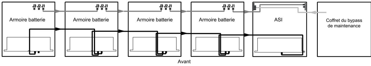
1. Acheminez le câble de disjoncteur de batterie du port J1, dans la première armoire batterie modulaire, au port J3, dans l'armoire batterie modulaire adjacente. Répétez la procédure pour toutes les armoires batterie modulaire.
