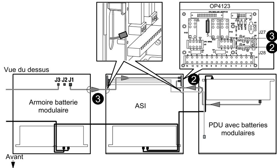
4. Acheminez le câble de communication du port de communication XR 1, dans chaque armoire batterie modulaire, au port 2 de l'armoire batterie modulaire adjacente. Enlevez si nécessaire le bouchon de terminaison.
