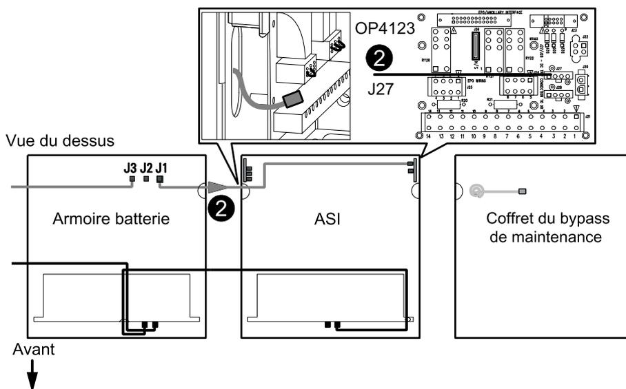
3. Acheminez le câble de communication du port de communication XR 1, dans chaque armoire batterie modulaire, au port 2 de l'armoire batterie modulaire adjacente. Enlevez si nécessaire le bouchon de terminaison.
