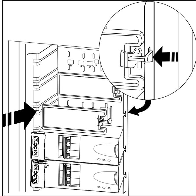
12. Installez le verrou d'emplacement en appuyant pour l'enfoncer dans les emplacements.
