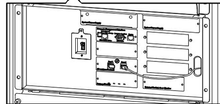
5. Acheminez les câbles de communication du coffret du bypass de maintenance à la carte d'interface de bypass de maintenance (0P3199) de l'ASI.
