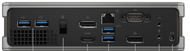
2 x ports USB 3.1 Gen 1    Clé de sécurité Kensington    DP/HDMI    LAN/ 2 x ports USB 3.1 Gen 1    Port COM/ DP    Écouteurs/ microphone    Connecteur d'alimentation
