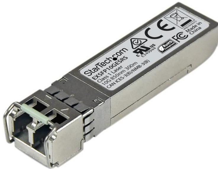
Le modèle EXSFP10GESRS est un module de transceiver à fibre optique compatible avec Juniper EX-SFP-10GE-SR, qui a été conçu, programmé et testé pour fonctionner avec les commutateurs et routeurs de la marque Juniper®. Il fournit une connectivité 10 GbE fiable sur câble à fibre optique pour les réseaux conformes aux spécifications 10GBASE-SR, avec une distance maximale de 300 m.
