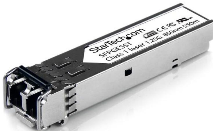
Le modèle SFPGESST est un module de transceiver à fibre optique compatible avec Cisco SFP-GE-S, qui a été conçu, programmé et testé pour fonctionner avec les commutateurs et routeurs de la marque Cisco®. Il fournit une connectivité 1 GbE fiable sur câble à fibre optique pour les réseaux conformes aux spécifications 1000BASE-SX, avec une distance maximale de 550 m.
