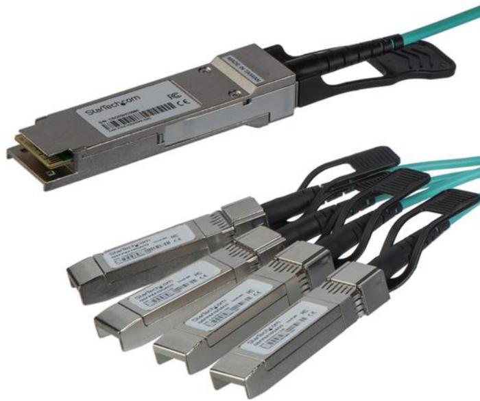
Le modèle SFP4X10AO15 est un câble optique répartiteur QSFP+ compatible avec Cisco QSFP-4X10G-AOC10M, qui a été conçu, programmé et testé pour fonctionner avec les commutateurs et routeurs de la marque Cisco®, ainsi que pour respecter les normes MSA. Connectant un port QSFP+ unique (40 GbE) à quatre ports SFP+ 10G, ce câble répartiteur optique actif est échangeable à chaud, ce qui facilite les mises à niveau et les remplacements en minimisant les interruptions sur le réseau.
