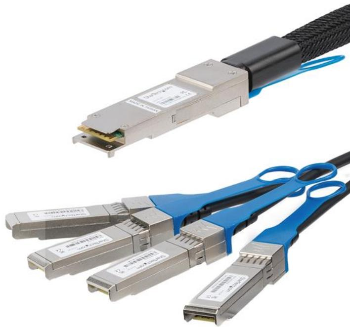
Le modèle QSFP4SFPPC3M est un câble répartiteur Twinax à fixation directe QSFP+ conforme aux normes MSA. Il est conçu, programmé et testé pour relier un équipement réseau 40G avec des serveurs ou des routeurs compatibles 10G. Ce câble Twinax passif connecte un port QSFP+ unique à quatre ports SFP+ 10G. Entièrement échangeable à chaud, il facilite les mises à niveau et les remplacements en minimisant les interruptions sur le réseau.
