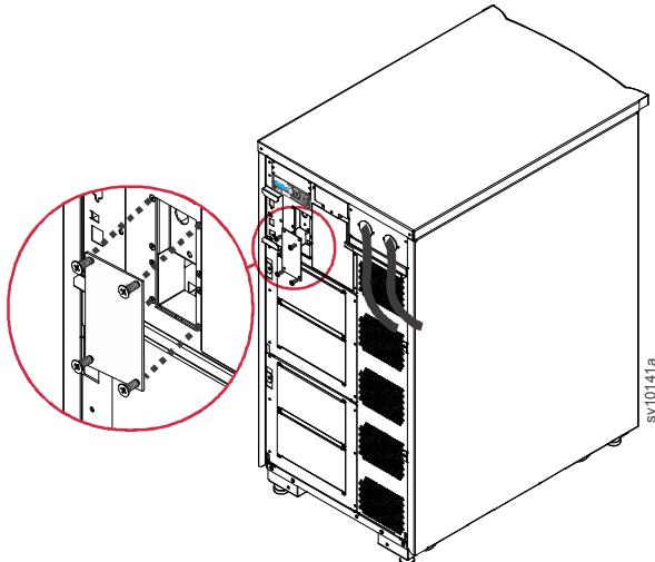
För en installation som använder en extern växelkontakt, anslut REPO-omkopplaren till en befintlig bygel.
