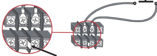
För en installation som använder en omkopplarkontakt och en extern strömförsörjning på 24 V, ta bort bygeln och anslut REPO-omkopplaren med en kabel och ringslang till den externa strömförsörjningen.
