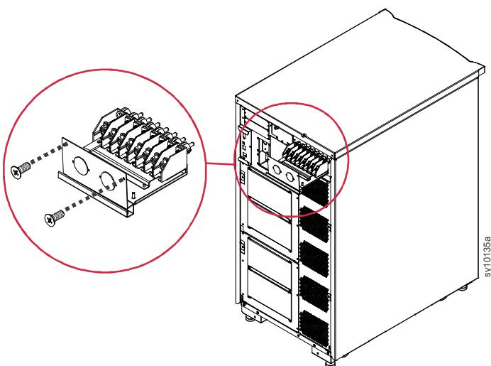
Sätt in en ledning av lämplig storlek genom hålen för dragavlastning i AC-facket.
