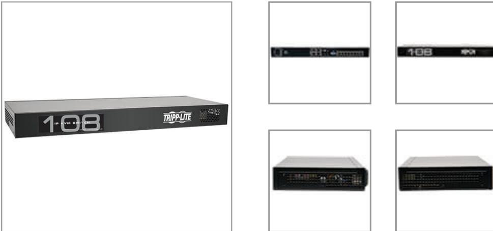
Contrôlez jusqu'à 8 ordinateurs depuis quasiment n'importe où avec un seul commutateur KVM Cat5. Ce commutateur KVM avec accès à distance par IP constitue une solution intelligente pour un contrôle efficace des serveurs. Les câbles peu coûteux Cat5 permettent de placer les serveurs à une distance jusqu'à 30 mètres.
