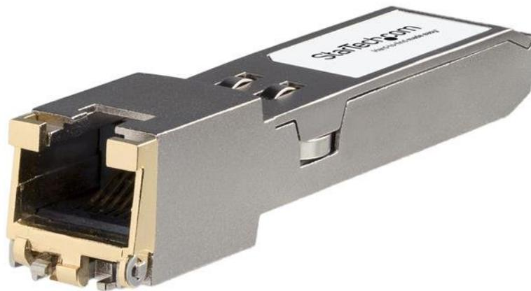
Le JL563A-ST est un module de transceiver SFP+ cuivre compatible HP JL563A qui a été conçu, programmé et testé pour fonctionner avec des commutateurs et des routeurs de marque HP®. Il vous assure une connectivité de 10 GbE par câble en cuivre, sur les réseaux compatibles 100/1000/10000Base-TX et sur une distance maximale de 30 m.
